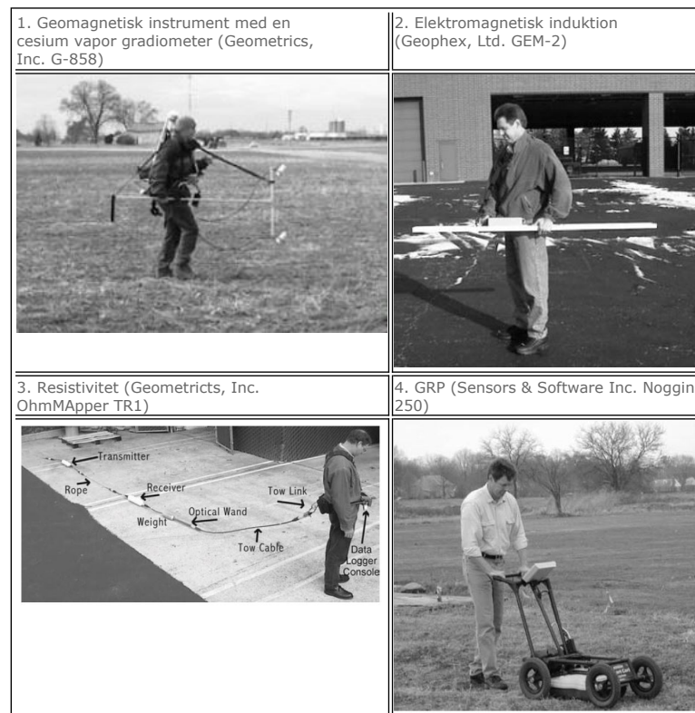
Figur 1. De fire forskellige geofysiske målemetoder/teknikker, der er forsøgt anvendt i til at lokalisere dræn i jorden.
